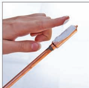
9. Verteilen Sie reichlich Kupferpaste auf den Kondensator
